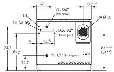
Verstellbarer Rauchrohranschluss hinten nur bei ZEH 90 und ZEH 110!
